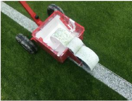
Мал. 18 Машинка для розмітки поля з колісним механізмом йде по лінії розмітки (зліва) та нанесення пунктирної розмітки (справа).
