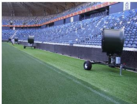
Мал.11 Приклад установки вентиляторів та охолоджувальних фенів для підтримки здорового газону.
