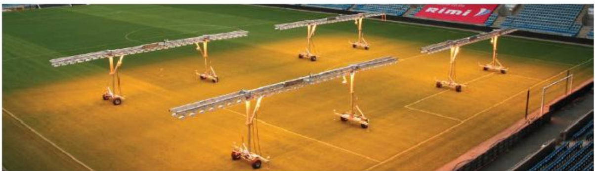
Мал. 12 Освітлювальні установки із кріпленням за принципом «складених» рукавів (зверху) та «зчеплених» рукавів (знизу)
