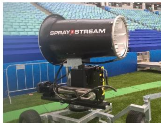
Мал.11 Приклад установки вентиляторів та охолоджувальних фенів для підтримки здорового газону.
