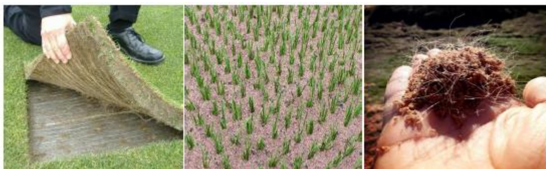
Мал. 5 Види системи зміцнення газону. Зліва направо: килим, техніка прошивки та волокно.
